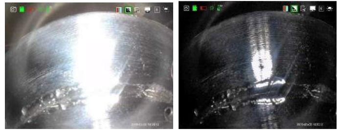
曝光設置：曝光抑制，拋光物體也能清晰可見 曝光補償，檢測大腔體更加高效清晰
