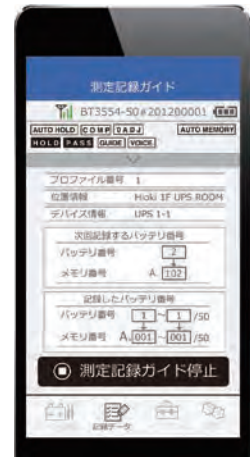
語音指引 UPS檢修時的測量順序
