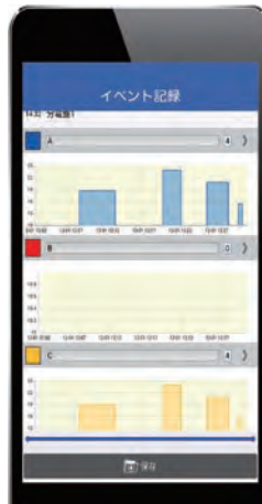
記錄間歇漏電的發生
