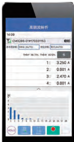
最多30次的諧波分析 確認電源品質
