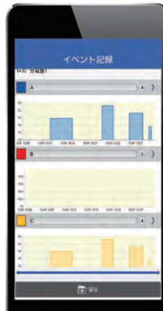
記錄間歇漏電的發生
