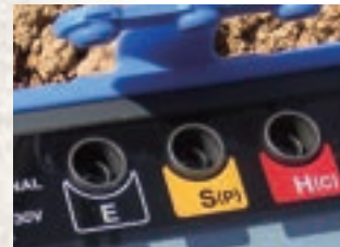
即使端口保護蓋打開時也有 IP67 安全極別
